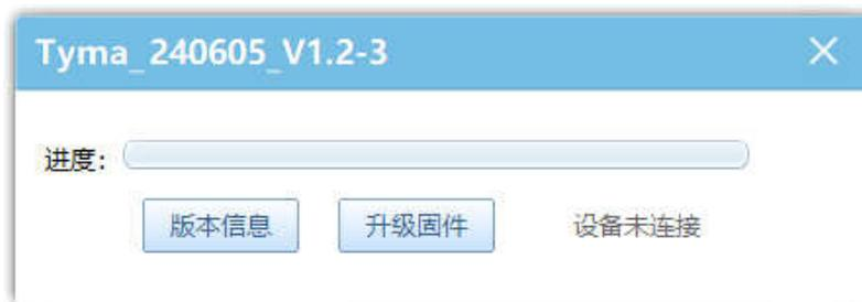
7、单击“版本信息”按钮，有设备信息显示即为连接成功，单击“OK”关闭当前弹出窗口。连接成功后，软件主界面右侧也会有“设备已连接”字样。
